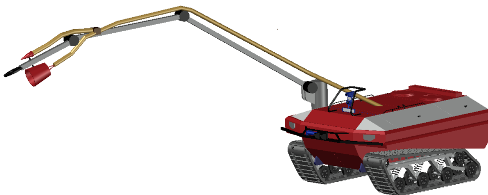
Рис. 4. – Общий вид универсальной беспилотной платформы с рабочим оборудованием для выполнения операций пожаротушения
