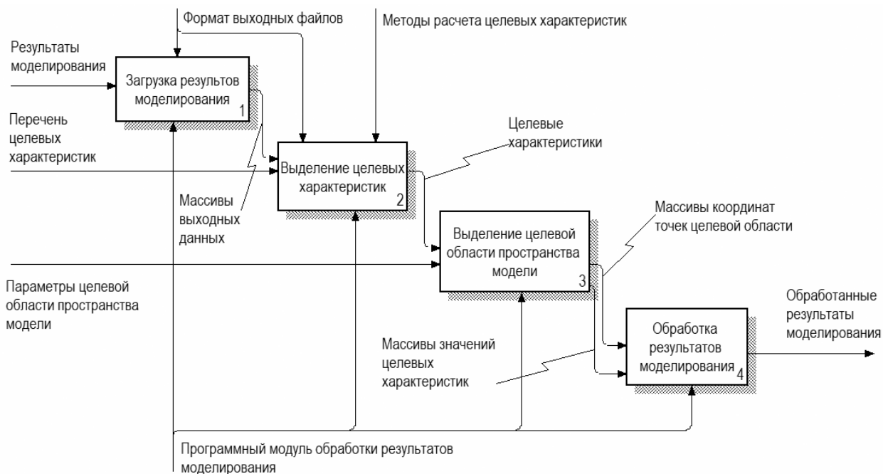
Рис. 1. – Функциональная диаграмма методики автоматизированной оценки t_{пор}
